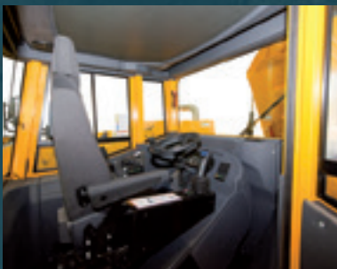
Drehsitz für beste Übersicht und Transportleistung.
