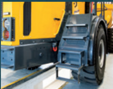
Sicherer Auf- und Abstieg außerhalb der Gefahrenbereiche und im Sichtfeld des Fahrers.
