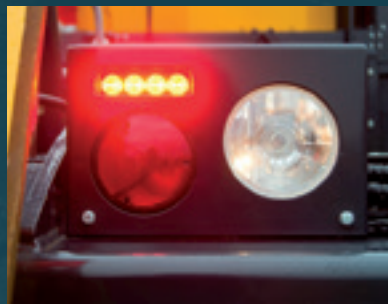
Heckblitzleuchten ergänzen die akustischen Warnsignale für Fremd- und Eigensicherung.
