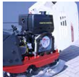
Einfach zu öffnende Haube für unbehinderten Zugang bei Wartungsarbeiten
