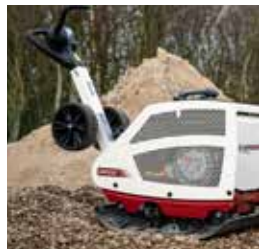
Breite, stichfeste Räder für einfachen Positionswechsel vor Ort
